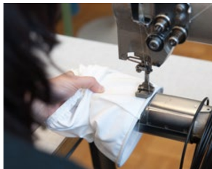
Confección de mangas de conexión
