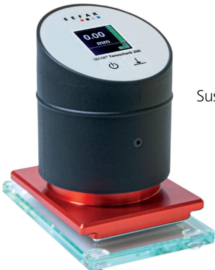
SEFAR® Tensocheck 200 el medidor electrónico para controlar la tensión de la pantalla.
